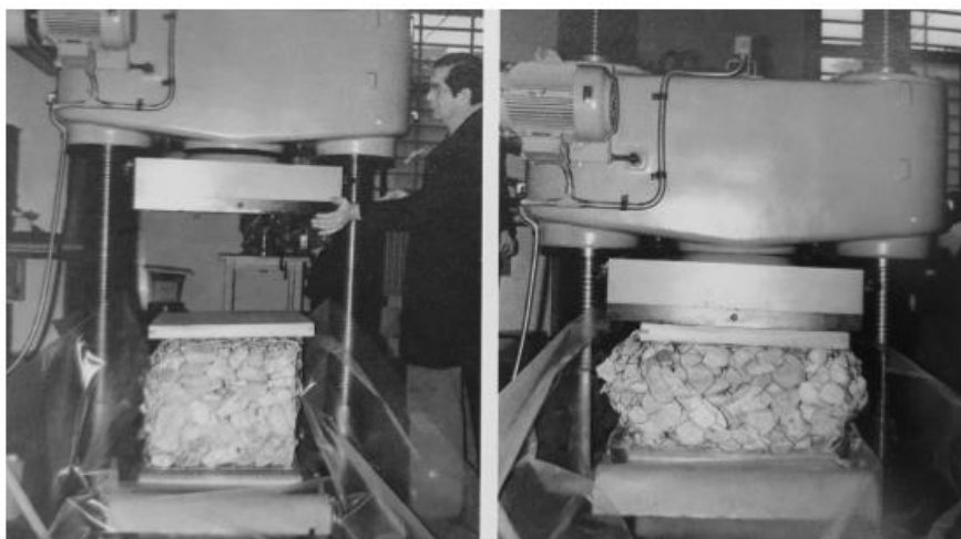
Figura 69. Ensaio de compressão em gabiões.
