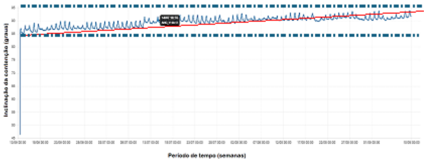
Figura 10. Histórico da variação da inclinação visualizado através da interface web.
