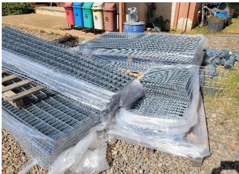
Figura 7 – Painéis do gabiões eletrosoldados
